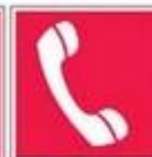
Телефон для использования при пожаре (в том числе телефон прямой связи с пожарной службой)
