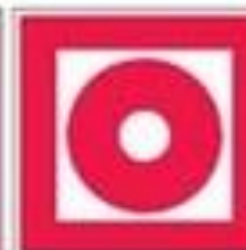
Кнопка вызова услуг (система) пожарной безопасности
