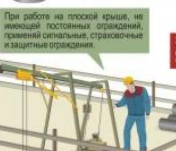
При работе на плоской крыше, не имеющей постоянных ограждений, применей сипальные, страховочные и защитные ограждения.
