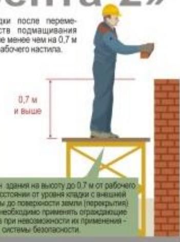
При кладке стен здания на высоту до 0,7 м от рабочего настила и расстояния от уровня кладки с винтовой стороны стены до поверхности земли (перекрытия) более 1,8 м, необходимо применять ограждающие устройства, а при невозможности их применения – системы безопасности.
