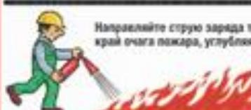
Направляйте струю заряда только с наветренной стороны, на ближний край очага пожара, уступаясь постепенно, по мере тушения
