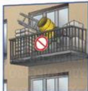
**И**спользовать балконы ремонтируемых зданий в качестве грузовых площадок для приема материалов, вспомогательного оборудования и инструмента **ЗАПРЕЩАЕТСЯ**
