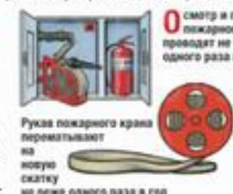
Рукав пожарного крана перематывают на новую скатку не реже одного раза в год
