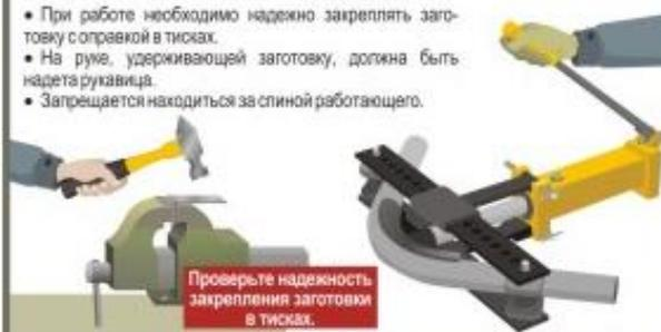
Проверьте надежность закрепления заготовки в тисках.
