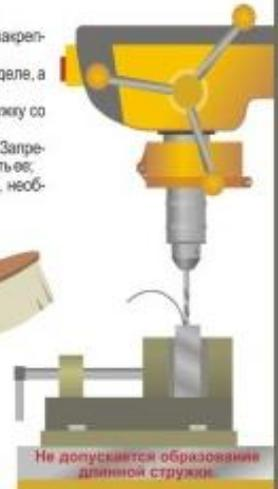
Не допускается образование длинной стружки.
