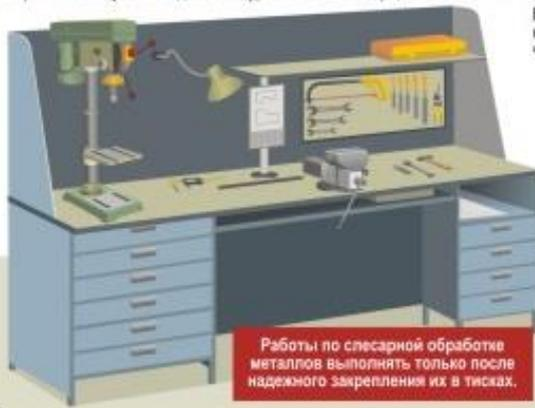
Работы по слесарной обработке металлов выполнять только после надежного закрепления их в тисках.
