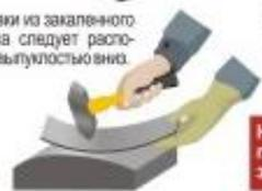
Не допускается править и рихтовать заготовки с трещинами.
