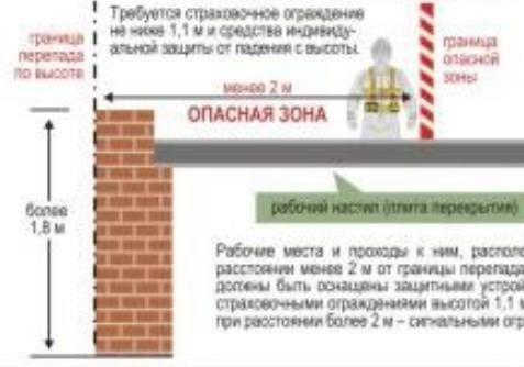
Рабочие места и проходы к ним, расположенные на расстоянии менее 2 м от границы перепада по высоте, должны быть оснащены защитными устройствами или страховочными ограждениями высотой 1,1 м и более, а при расстояниях более 2 м – сигнальными ограждениями.
