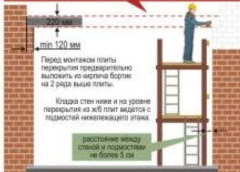
Высота каждого этажа стены устанавливается с таким расчетом, чтобы уровень кладки после поднятия средств подицвивания был не менее чем на 2 ряда выше уровня нового рабочего настила.
