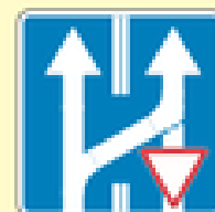
5.15.8 д Начало перестройки на параллельную проезжую часть
