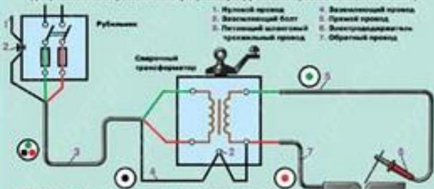
Для защиты от поражения током высокого напряжения на корпус сварочной электродержатель и изоляционную оболочку сварочного трансформатора. При наличии от фазного напряжения предохранитель в нулевой провод цепи!
