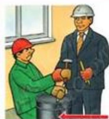
Для открытия баллона с карбидом клапан закручивается по часовой стрелке. Делать этого только специальным ключом по схеме.
