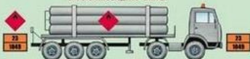
ТРАНСПОРТНАЯ ЕДИНИЦА С ТРЕХСЕКЦИОННОЙ ЦИСТЕРНОЙ
