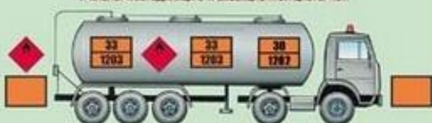
ТРАНСПОРТНАЯ ЕДИНИЦА С ТРЕХСЕКЦИОННОЙ ЦИСТЕРНОЙ
