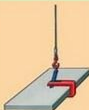
Лист горизонтально. Вертикальный строп со специальными захватами
