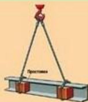
Швеллер. Для универсальных поточных стропов - в обхват
