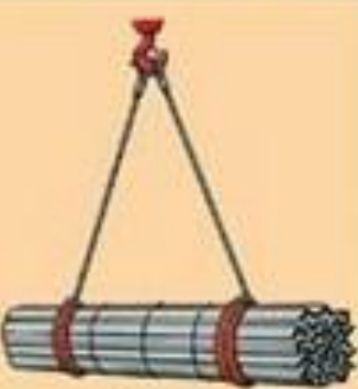
Связка труб. Для универсальных поточных стропов - в обхват
