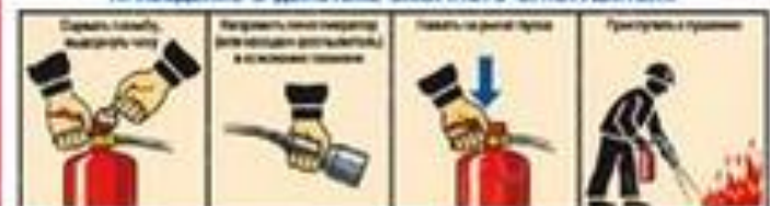
ПРИВЕДЕНИЕ В ДЕЙСТВИЕ ЗАКАЧНОГО ОГНЕТУШИТЕЛЯ
