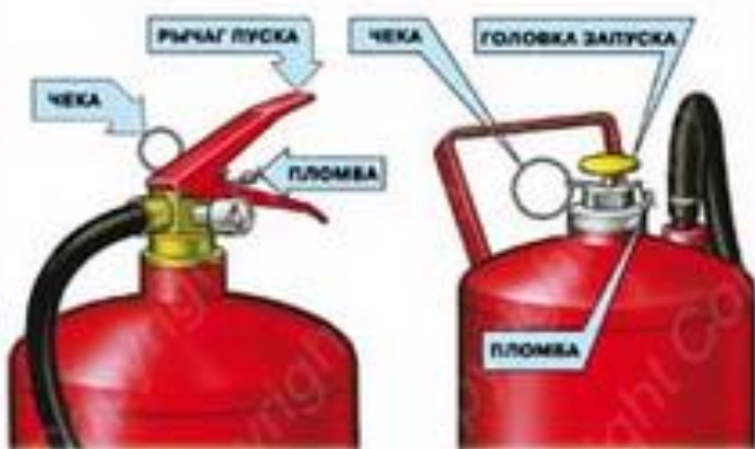
ПРИВЕДЕНИЕ В ДЕЙСТВИЕ ОГНЕТУШИТЕЛЯ С ГАЗОВЫМ БАЛЛОНОМ
