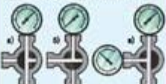
Положение трехходового крана: а) рабочий; б) при плавном "топе"; в) при проверке исправности рабочего манометра контрольным
