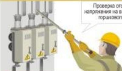
Проверка отсутствия напряжения на выключателе горшкового типа
