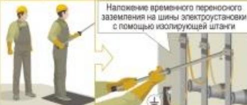
Наложение временного переносного заземления на шины электроустановки с помощью изолирующей штанги
