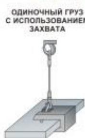
ОДНОЧНЫЙ ГРУЗ С ИСПОЛЬЗОВАНИЕМ ЗАХВАТА
