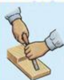
Зачистка подрезанного места
