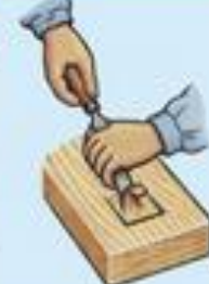
Зачистка поверхности гнезда
