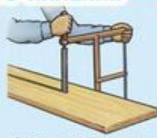
При продольном распиливании держите пилу вертикально
