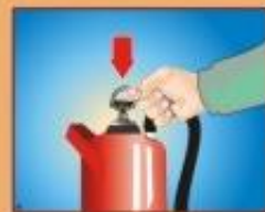
Снять пломбу. Выдернуть чеку. Нажать на рычаг или ударить по корпусу.
