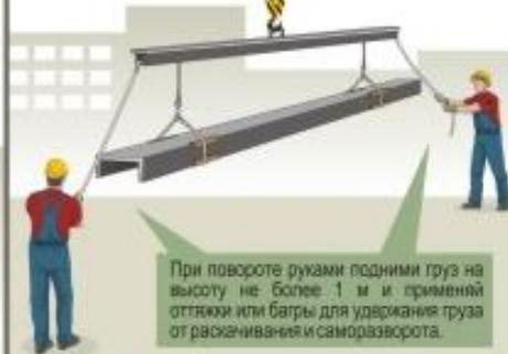
При повороте руками подними груз на высоту не более 1 м и применй оттяжки или багры для удержания груза от раскручивания и саморазворота.
