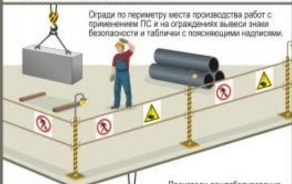
Огради по периметру места производства работ с применением ПС и на ограждениях вывесь знаки безопасности и таблички с пожарными надписями.
