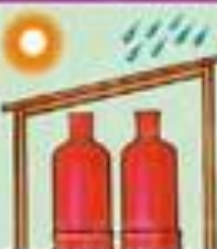
Защитить баллоны от солнца и осадков (температура эксплуатации корпуса баллона +40 °С)
